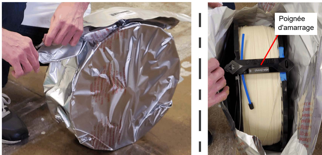
Figure 10 : À l'intérieur du sac de bobine de matériau
