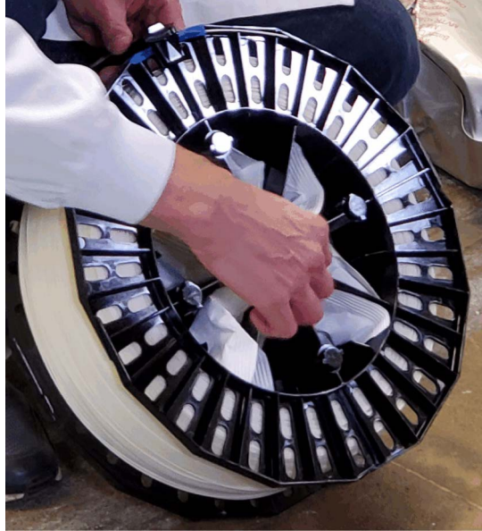
Figure 11 : Retrait des sachets déshydratants
