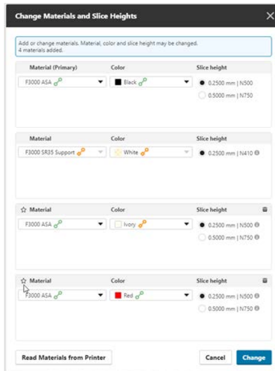
Figure 22 : Modifier les matériaux et les hauteurs de coupe
