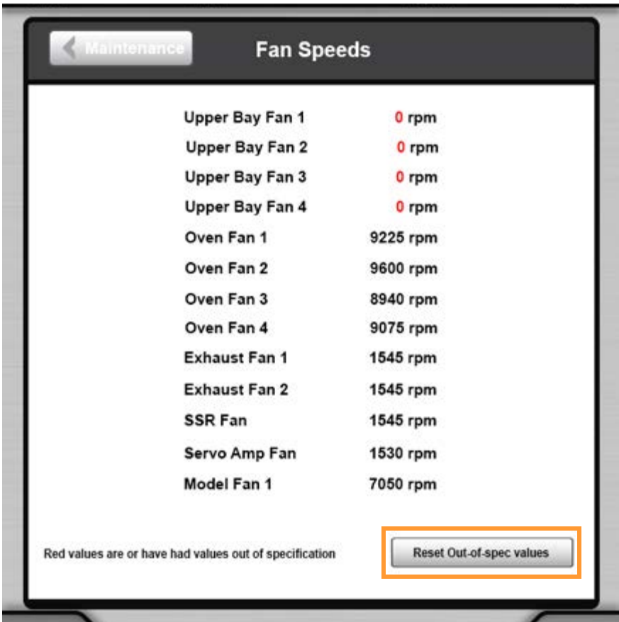
Figure 4-80 : Page des vitesses des ventilateurs - ventilateurs hors spécification
