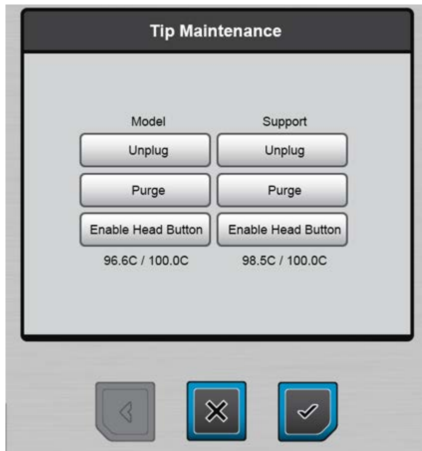
Figure 4-31 : Page de maintenance des embouts
