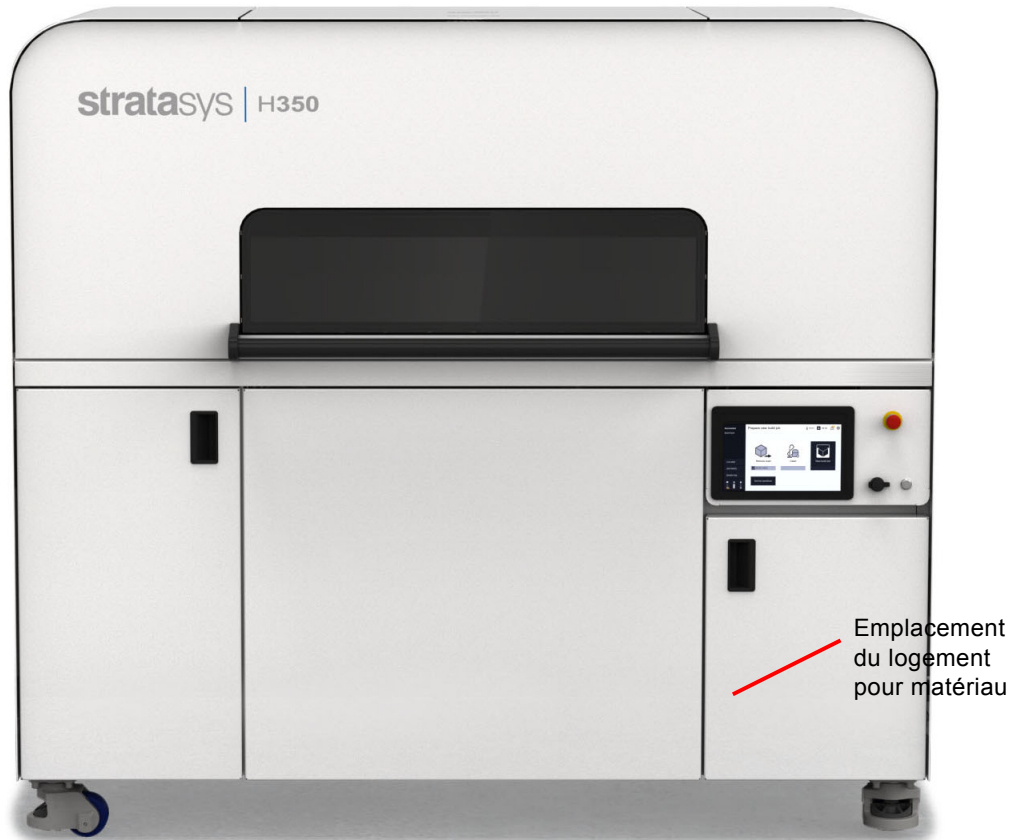
Figure 27 : Emplacement du logement pour matériau
