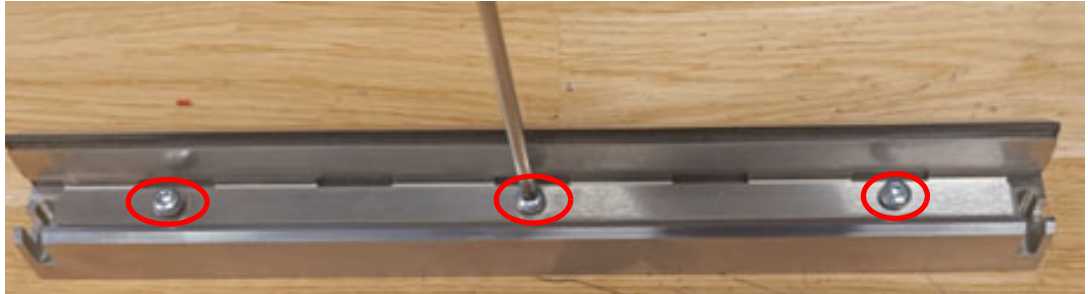
Figure 111 : Serrage des vis sur le grattoir
