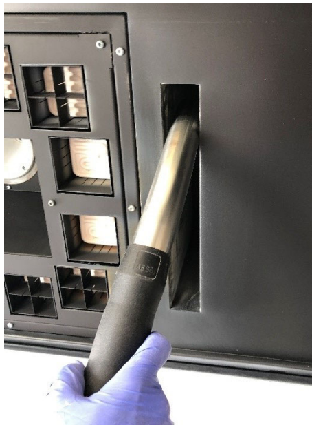
Figure 84 : Passez l'aspirateur sur le couvercle
