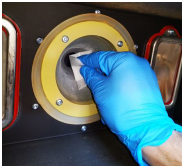
Figure 78 : Nettoyer la fenêtre thermique
