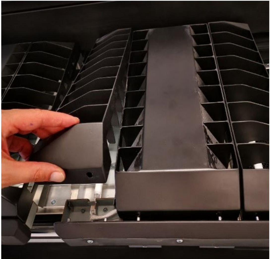
Figure 11 : Retrait du couvercle de la lampe du chariot d'impression
