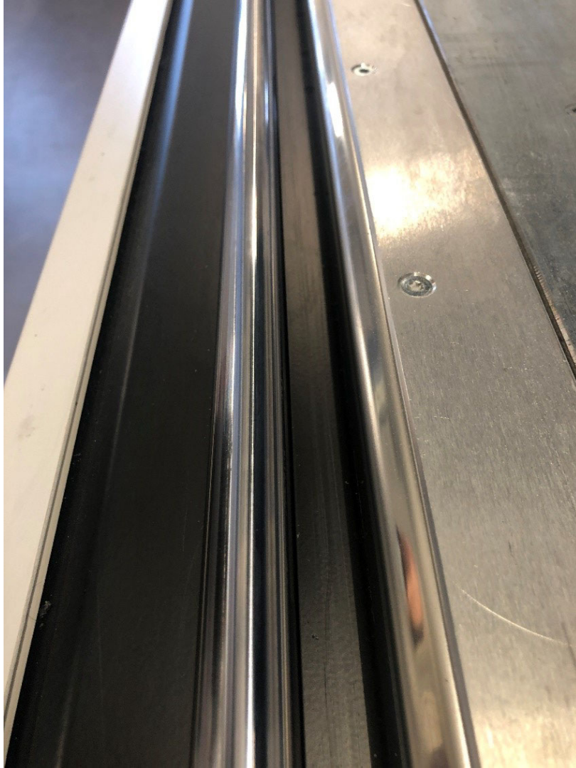
Figure 74 : Guides de chariot nettoyés
