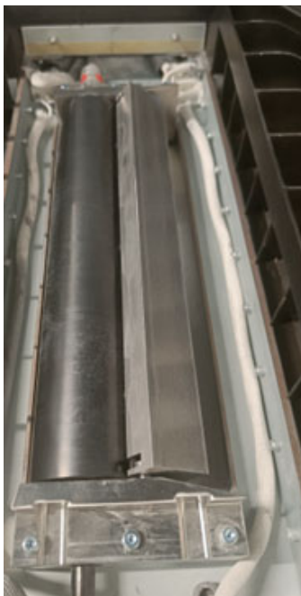
Figure 112 : Extrémité du grattoir nettoyant le rouleau
