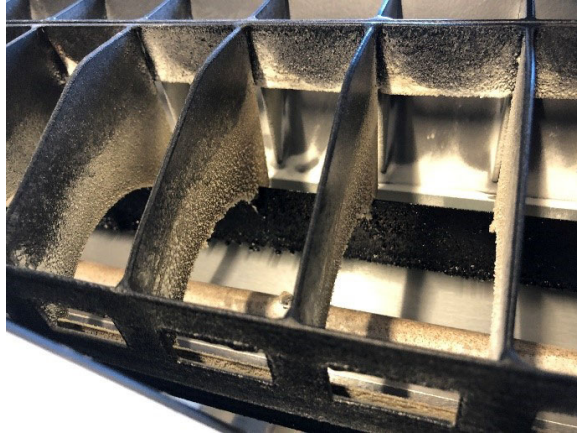
Figure 31 : Couvercle de la lampe avec poudre fondue
