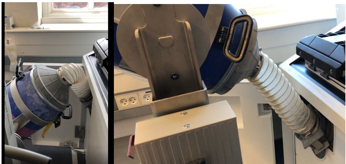
Figure 37 : Soulever le conteneur de poudre
