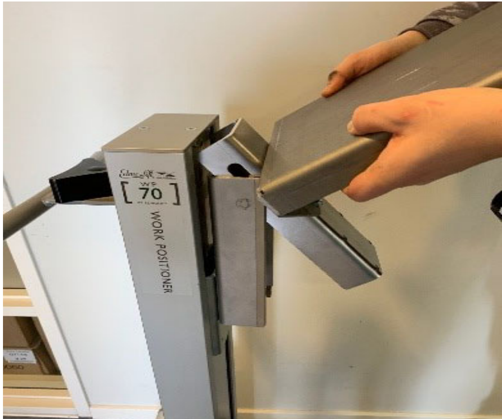
Figure 52 : Montage du support de la boîte de retrait de la fabrication sur le chariot en H
