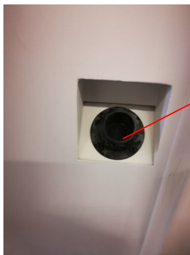
Figure 90 : Retirer le couvercle d'extraction de poudre sous vide
