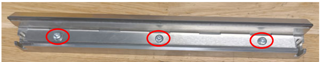
Figure 108 : Desserrez trois vis Torx
