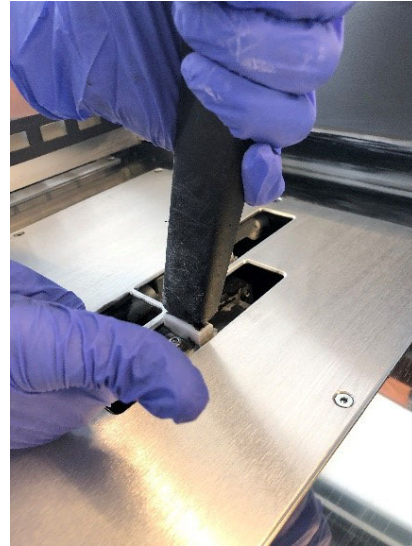
Figure 81 : Nettoyage à l'aspirateur des buses de nettoyage obstruées de la tête d'impression
