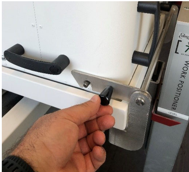
Figure 61 : Déverrouiller la boîte de retrait de la fabrication
