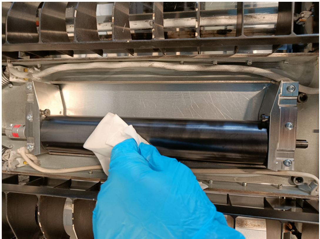
Figure 16 : Nettoyage du rouleau de distribution avec IPA
