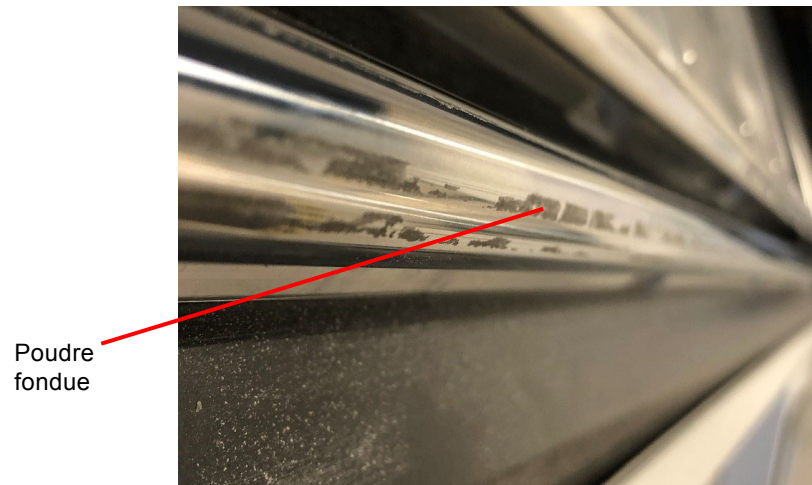
Figure 71 : Guide du chariot avec poudre fondue
