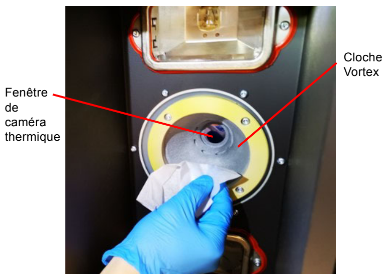
Figure 75 : Cloche Vortex et fenêtre de caméra thermique
