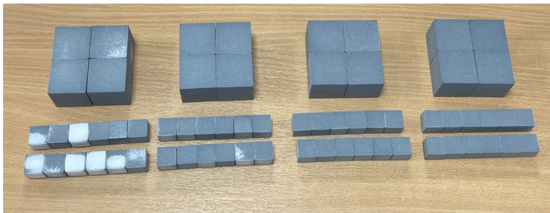
Figure 5 : Blocs de calibrage thermique par niveau
