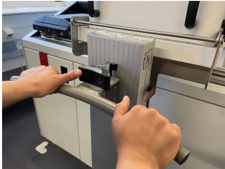
Figure 70 : Bac soulevé au-dessus de l'imprimante et boîte de retrait de la fabrication libérée du guide du chariot
