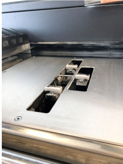
Figure 81 : Nettoyage à l'aspirateur des buses de nettoyage obstruées de la tête d'impression
