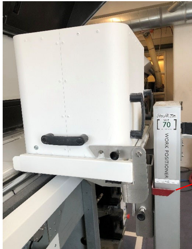
Figure 60 : La boîte de retrait de la fabrication n'est pas à niveau
