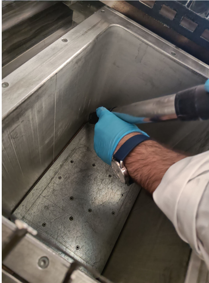
Figure 40 : Nettoyage du module de nettoyage des têtes d'impression
