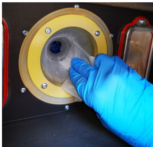
Figure 77 : Nettoyage de la surface de la cloche Vortex
