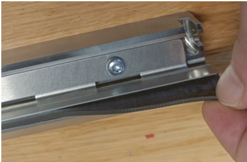
Figure 109 : Retrait de l'extrémité du grattoir
