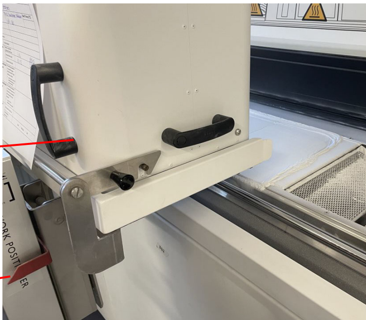
Figure 57 : Boîte de retrait de la fabrication soulevée au-dessus du niveau de la plaque supérieure de l'imprimante
