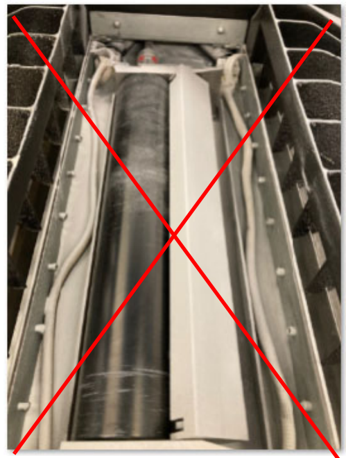
Figure 112 : Extrémité du grattoir nettoyant le rouleau
