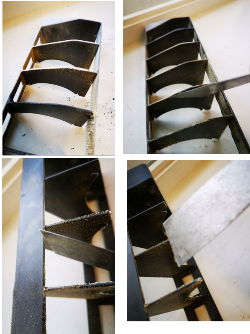
Figure 14 : Nettoyage des couvercles de chariot
