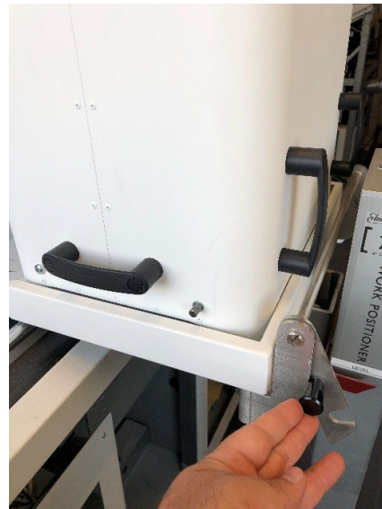
Figure 61 : Déverrouiller la boîte de retrait de la fabrication
