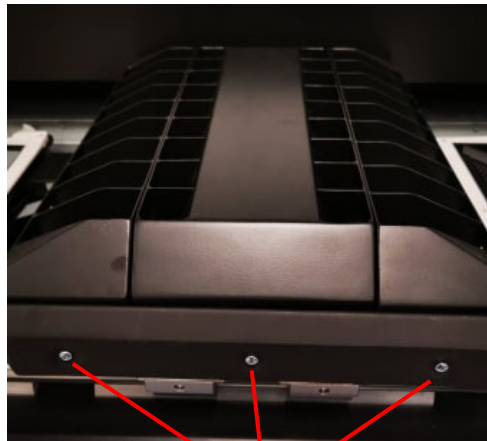
Figure 10 : Vis TX20 et goupilles de retenue
