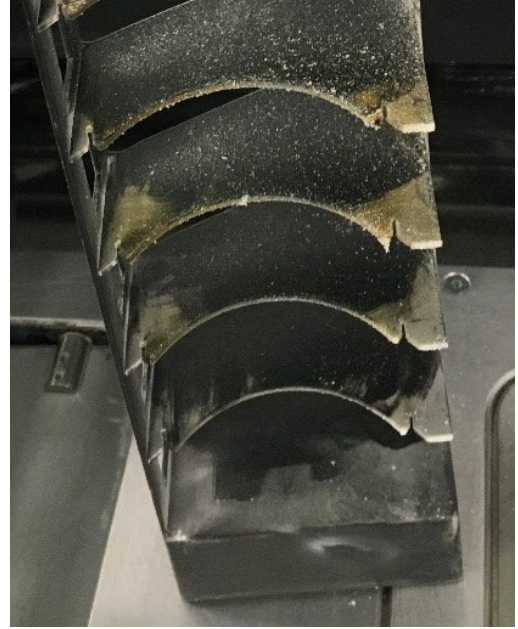
Figure 31 : Couvercle de la lampe avec poudre fondue
