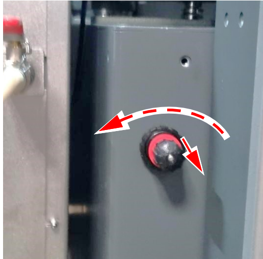
Figure 248 : Tirer sur la bague rouge puis tourner la vanne de purge
