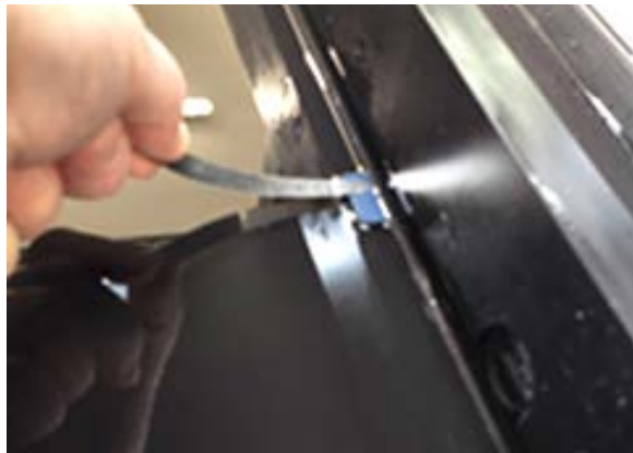
Figure 242 : Vérification de la hauteur de la lame de recouvrement avec une jauge d'épaisseur
