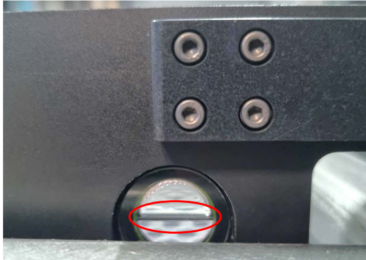
Figure 251 : Le niveau de résine apparaît au milieu du regard.
