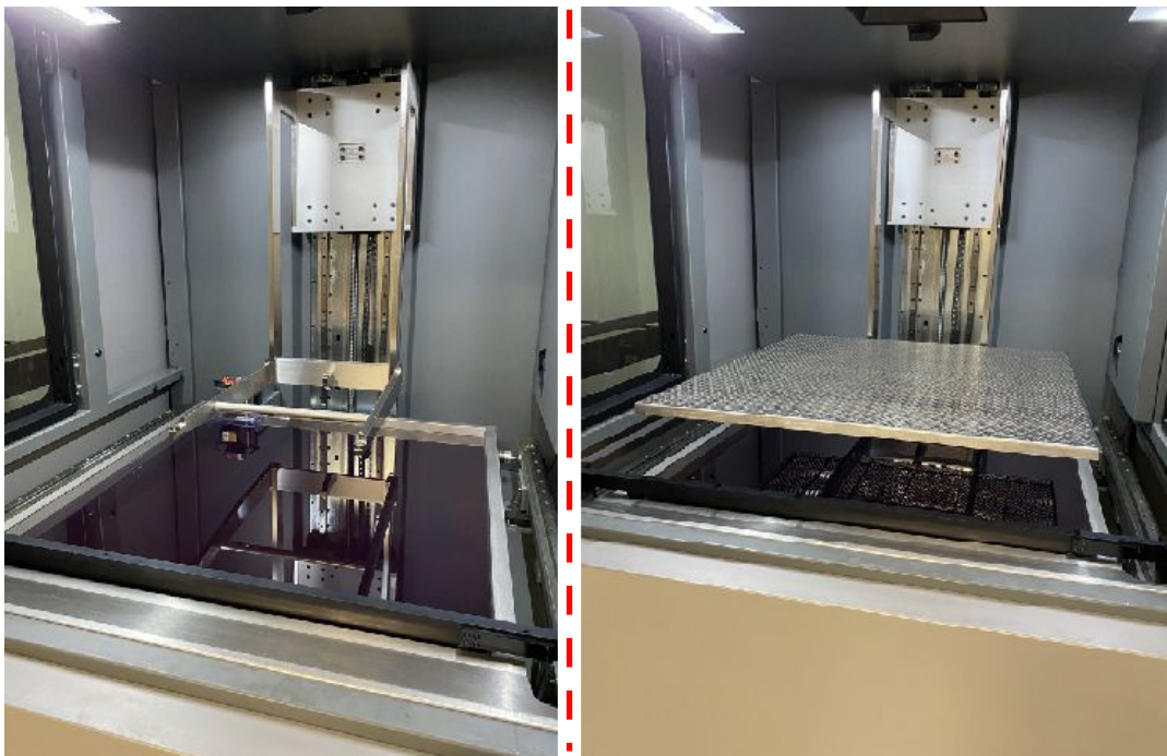
Figure 177 : Installation de la plateforme de fabrication
