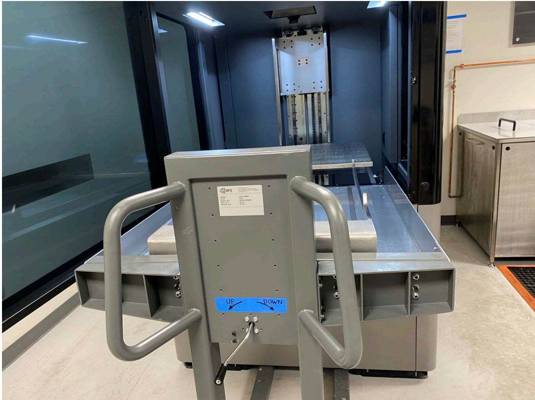
Figure 199 : Positionnement du chariot de déchargement
