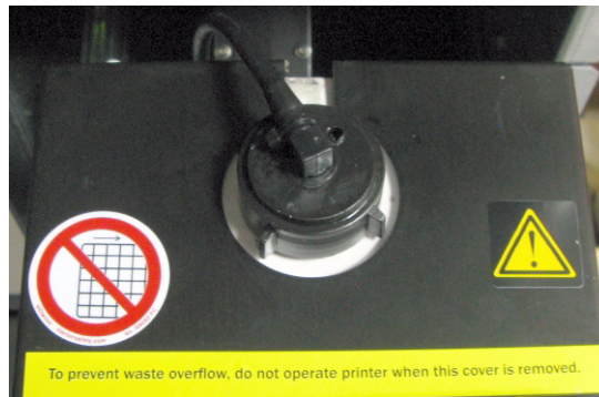
Figure 6-101 : Couvercle ignifugé installé sur le conteneur de déchets.
