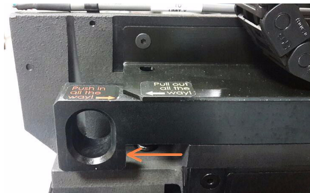
Figure 6-36 : Sortie des tubes d'évacuation du collecteur de déchets Important: Sortez le mécanisme de déblocage complètement .
