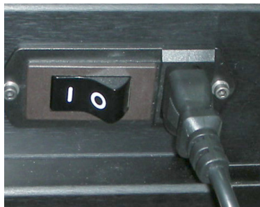
Figure 6-2 : Interrupteur d'alimentation principal et câble
