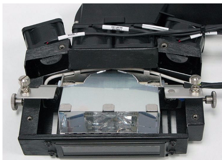
Figure 6-90 : Dépose du réflecteur d'UV de l'ensemble UV
