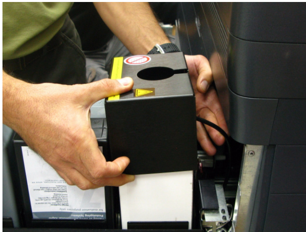
Figure 6-99 : Dépose du couvercle du conteneur de déchets
