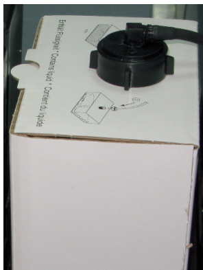
Figure 6-100 : Conteneur de déchets raccordé au tuyau d'évacuation
