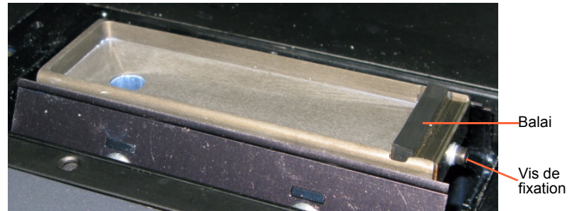
Figure 6-31: Balai et évacuation de matériau excédentaire
