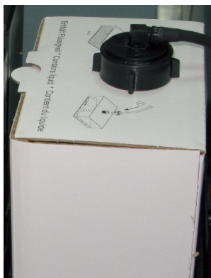
Figure 6-71 : conteneur de déchets raccordé au tuyau d'évacuation
