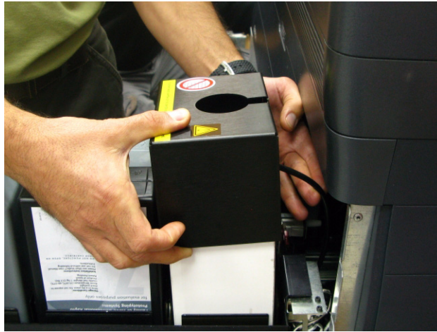
Figure 6-70 : Dépose du couvercle du conteneur de déchets
