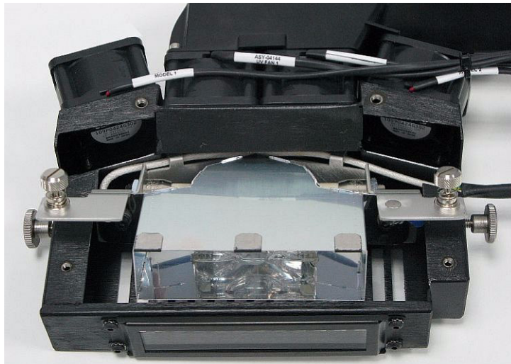
Figure 6-64 : Dépose du réflecteur d'UV de l'ensemble UV
