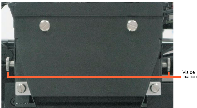
Figure 6-41 : Vis de fixation de l'ensemble de la lampe UV
