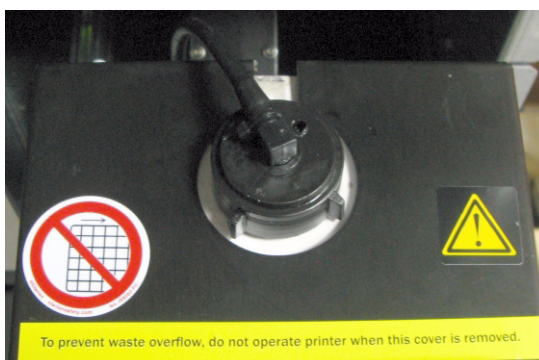
Figure 6-72 : Couvercle ignifugé installé sur le conteneur de déchets.
