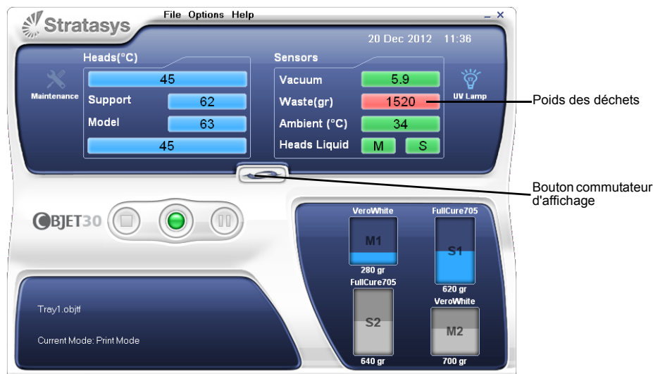
Figure 6-69 : Interface de l'imprimante, indiquant le poids des déchets (un arrière-plan rouge indique une alerte à l'opérateur)
