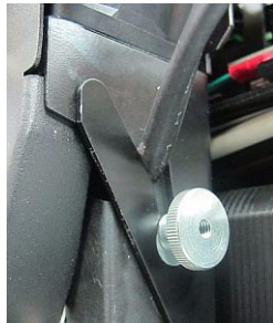
Figure 6-66 : Câble de la lampe UV après remise en place de l'ensemble
