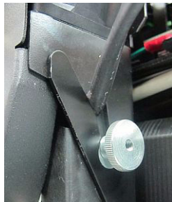
Figure 6-45 : Câble de la lampe UV remise en place après fixation de l'ensemble
