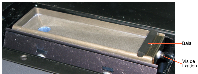
Figure 6-37 : Balai et évacuation de matériau excédentaire
