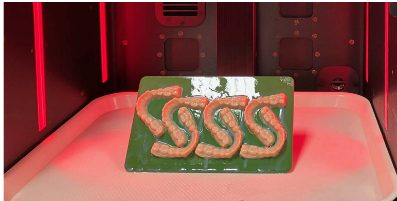
Figure 17 : Plateforme de fabrication placée sur le bac
