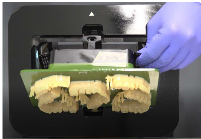
Figure 18 : Insertion de la plateforme de fabrication dans le gabarit de retrait de pièces
